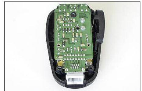
Bild 8: Fertig montierte Austauschplatine vor dem Zuschrauben des Gehäuses
