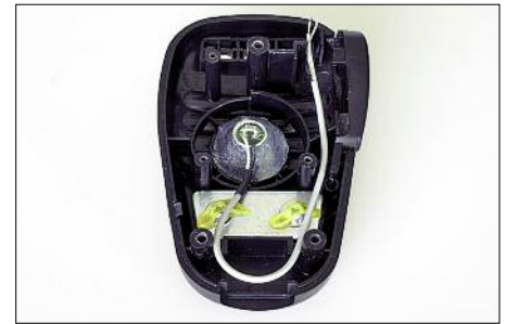
Bild 6: Das Ausgießen mit Heißkleber fixiert die Mikrofonkapsel, verschließt unerwünschte Schalleintrittsöffnungen und gewährleistet später einen sauberen Klang des Mikrofons.
